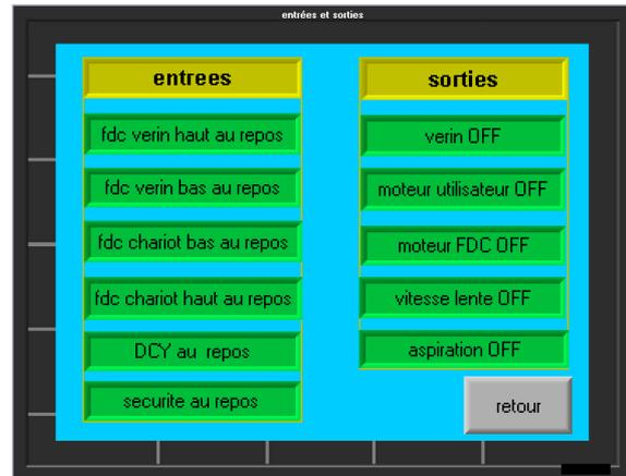
Indique l'état des capteurs et des actionneurs
